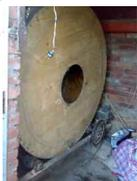
Теперь коротко опишу обычную конструкцию барабана. Основание изготовлено из металлического уголка, на котором крепится эл. двигатель с понижающим редуктором. Затем через цепную передачу вращение передаётся к самому барабану, который крепится к валу с помощью флянцев. Сбоку барабана расположено отверстие и крышка для загрузки шкур.
